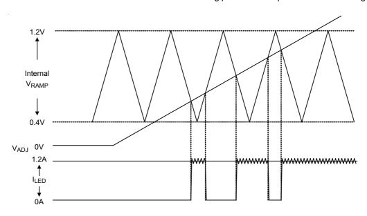
Figure 1. PWM Soft-Start Behavior Mechanism
