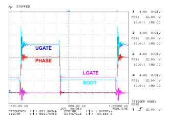
FIGURE 9. ISL6549LOW-EVAL1 SWITCHING WAVEFORMS
