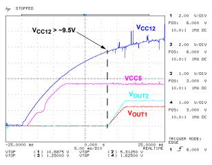
FIGURE 4. TYPICAL POWER-UP WAVEFORMS
