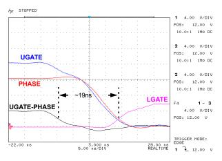
FIGURE 11. ISL6549 FALLING UGATE EDGE
